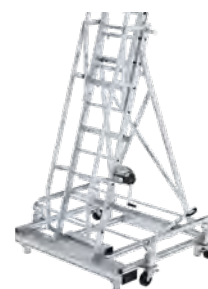
2 Lenkrollen inkl. Feststellbremse Ø 150 mm ableitfähig (Aufstieg) (Rollensatz gegen Mehrpreis elektr. ableitfähig # 301324 lieferbar)
